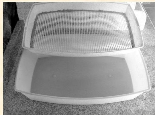
**Fig. 6.** - Dispositivo "sequeiro" de cama de gato. A malla, preferiblemente de plástico, fíxase aos bordes con silicona. Os refugallos do batido espállanse sobre a malla e déixanse repousar. A medida que secan as capas superficiais os pequenos animais van caendo ao compartimento inferior (Fotografías de Carlos Mejuto).
